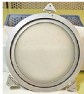
SD(Solar Diffuser) Dim : 14cm
